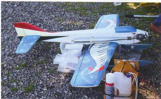
Ein Nachbau der Prettner Curare aus der frühen RC-I-Zeit; der 15er MVVS-Zweitakter mit Resonanzschalldämpfer verleiht dem Modell einen äußerst kraftvollen Flugstil.
