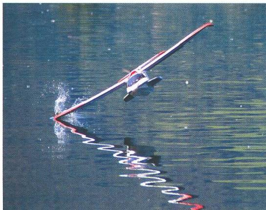
Das ICON-Amphibien-Flugzeug ist stabil und Anfänger-geeignet. Nach einem Strömungsabriss während eines zu langsamen Landeanflugs klatschte es einmal kräftig aufs Wasser und setzte unbeschadet die Rückfahrt zum Ufer fort.
