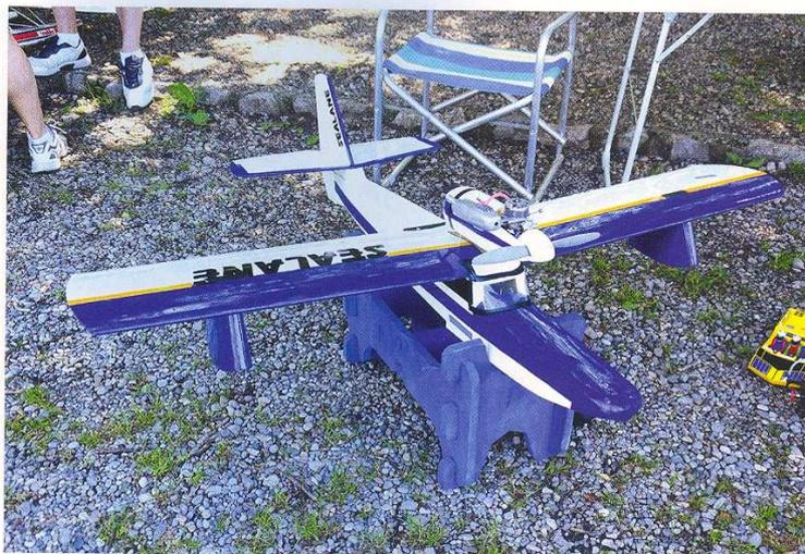
Diese Sealane von SIG / Kavan hat gut 1,5 m Spannweite und wird mit ihren 3 kg Fluggewicht von einem gut gedämpften Zweitakter-Verbrenner angetrieben.
